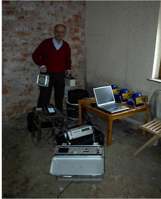
Abb. 1: Erfassung der Radonkonzentration vor Baubeginn
